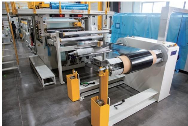
依托集团高性能碳纤维材料和经编织物的优势，新创碳谷引进和配套开发出高精密碳纤维多轴向经编织物预浸料生产线，拥有 100-600g/m<sup>2</sup> 纤维面密度、T300-T800 等级别的单向或织物预浸料生产经验，并形成了规格完善的预浸料材料体系。搭配如中温固化、阻燃、快速固化等类型的热固环氧树脂，可使产品充分满足风电、轨交、汽车、航空、体育用品等领域对高品质、高性能预浸料的需求。
